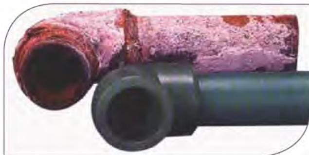
Comparaison entre un tube galvanisé et un tube en PEHD
